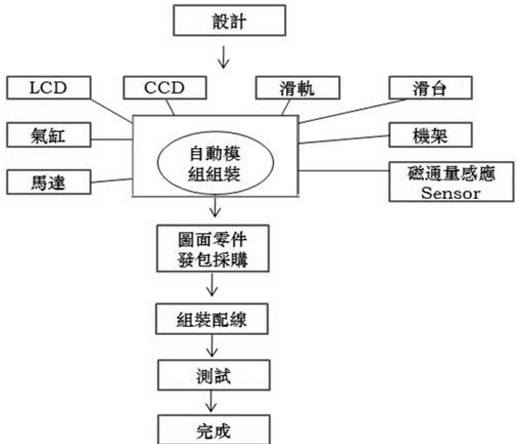
■多種類型 Mylar 貼裝機製造流程
