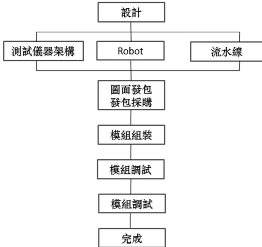
■磁通量量測機製造流程
